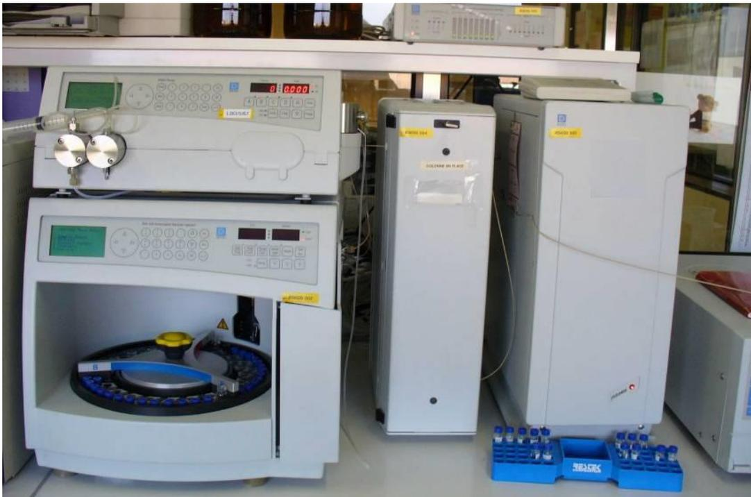
Figure 3 : photographie du système de chromatographie
