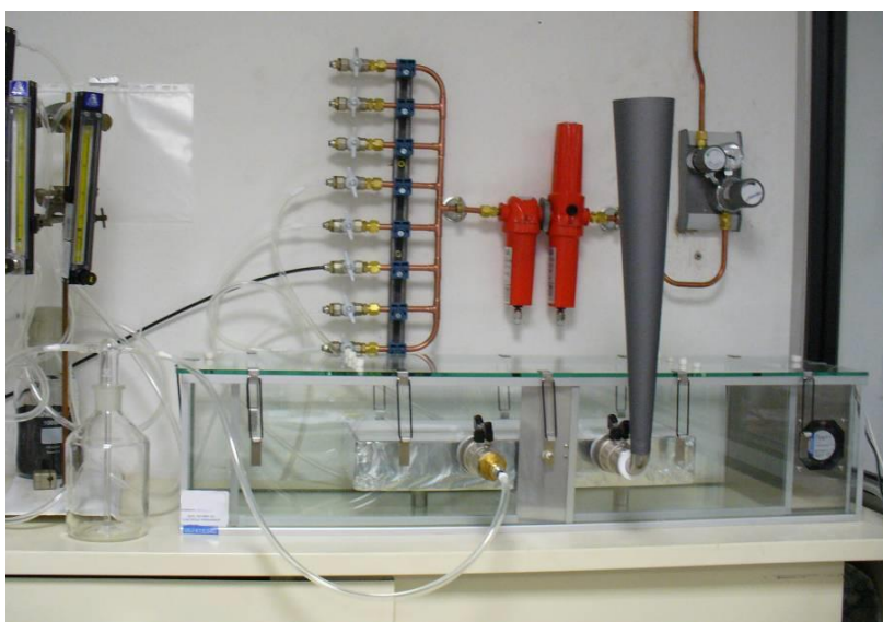
Figure 1 : chambre d'essai d'émission avec éprouvette
